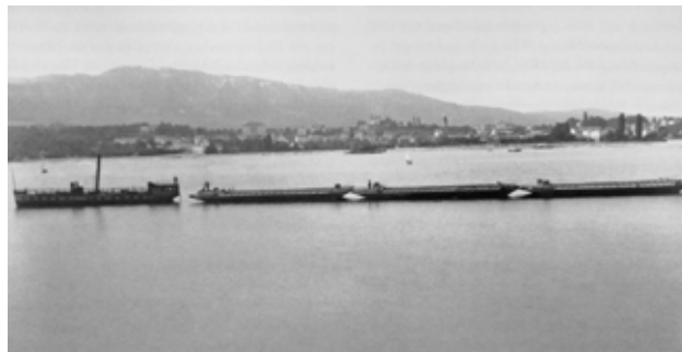
Ein Prahm ist ein flacher, eher kleiner Lastenkahn, der von einem Dampfschlepper gezogen wird. Die historische Aufnahme zeigt einen Schleppzug mit drei Prahmen.
