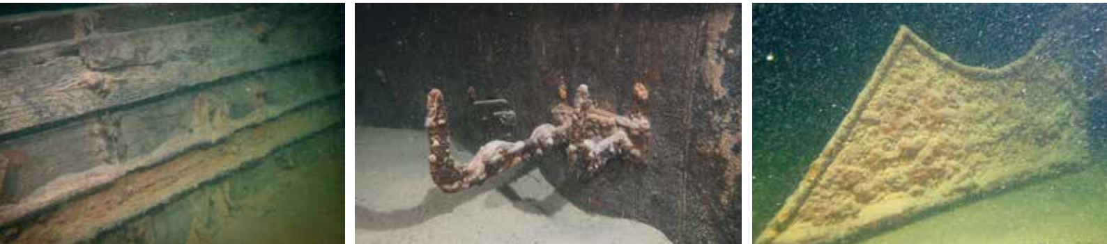
Links: Der Rumpf wurde in Komposit-Bauweise errichtet, aus Holz mit einem Stahlskelett. Mitte: Haken zum Verzurren des Ruders. Rechts: Die Form des Ruderblattes ist typisch für ein Schweizer Ledschiff.
