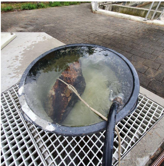
Gewicht- Bestimmung mittels Wasserverdrängung.
