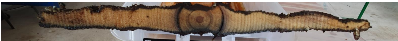
Plankenbrett für Dendrochronologie (Altersbestimmung) mit Total 50 Jahresringen.
