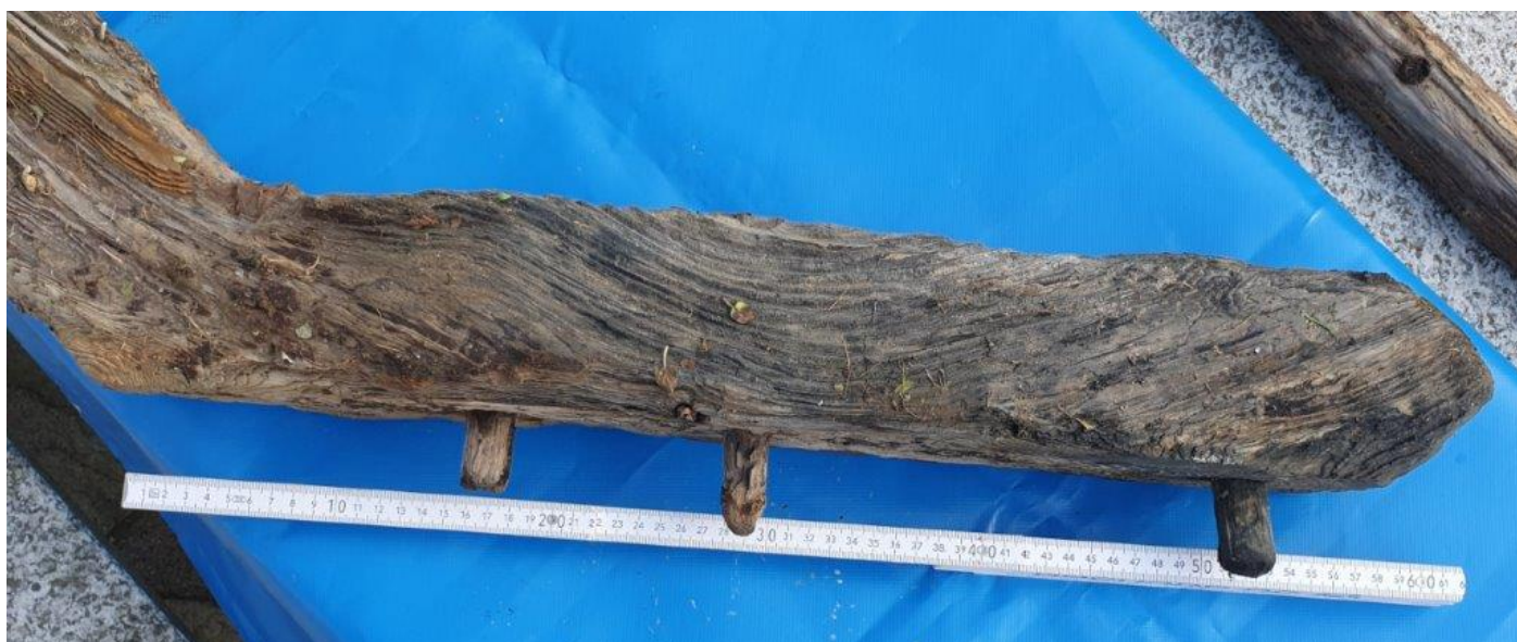
Gürbe (Krummholz) 4 Kant 10 x 12 cm zugehobelt. Holzstifte \varnothing 20 bis 22 mm (Bordwandhalterung)
