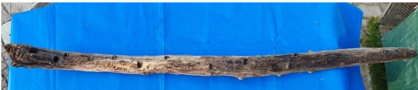
Gürbe Ø 6 cm (Krummholz) heckseitig mit Holzstiften Ø18 mm
