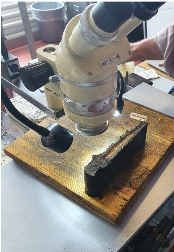
Plankenbrett unter dem Mikroskop
