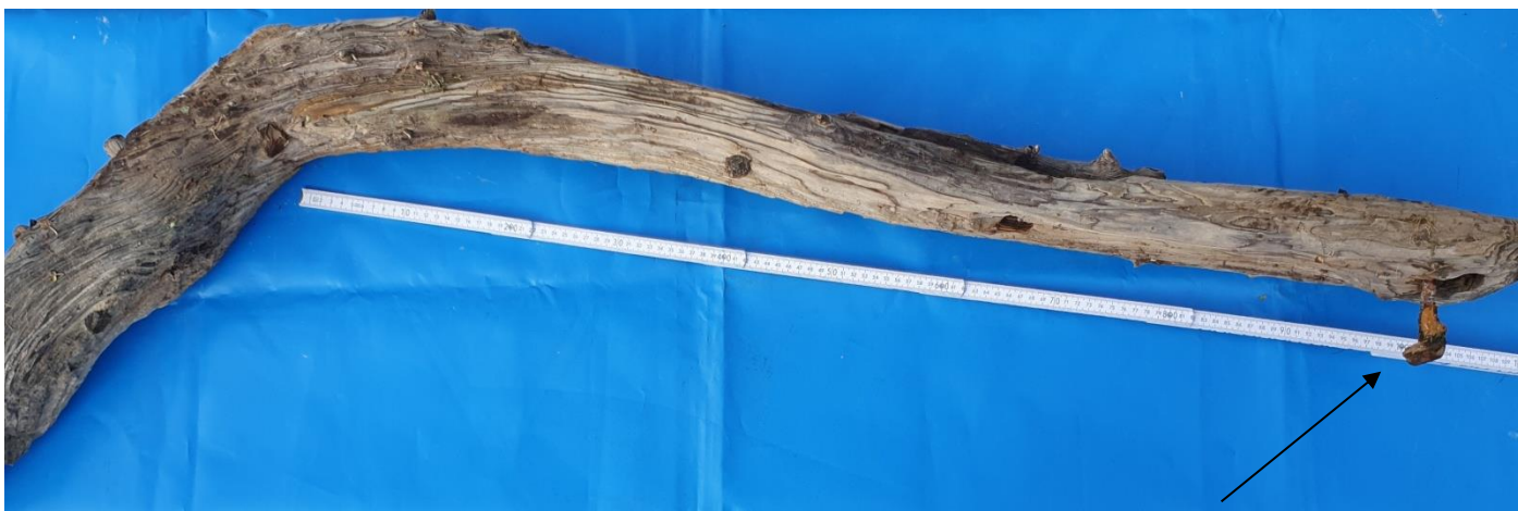
Gürbe Ø 10 bis 12 cm (Krummholz) mit Holzstiften Ø 20 bis 22 mm
