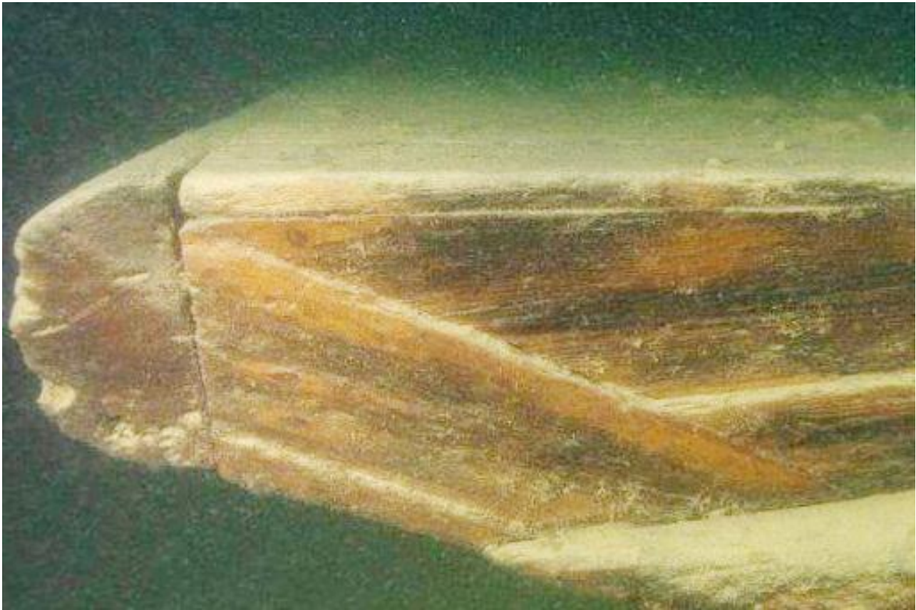
Wrack Wädenswil Nr. 1 Bug oder Heck. (Tannenholz) Beide Schleppkähne wurden aus Tannenholz angefertigt.
