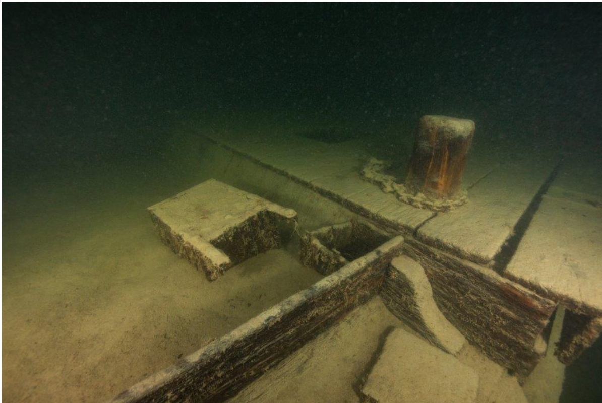
Wrack Nr. 2 Poller aus Holz mit Kette und umgekippter Ofen. Rechts vom Ofen, 4-Kant Loch zum setzen der Lenzpumpe
