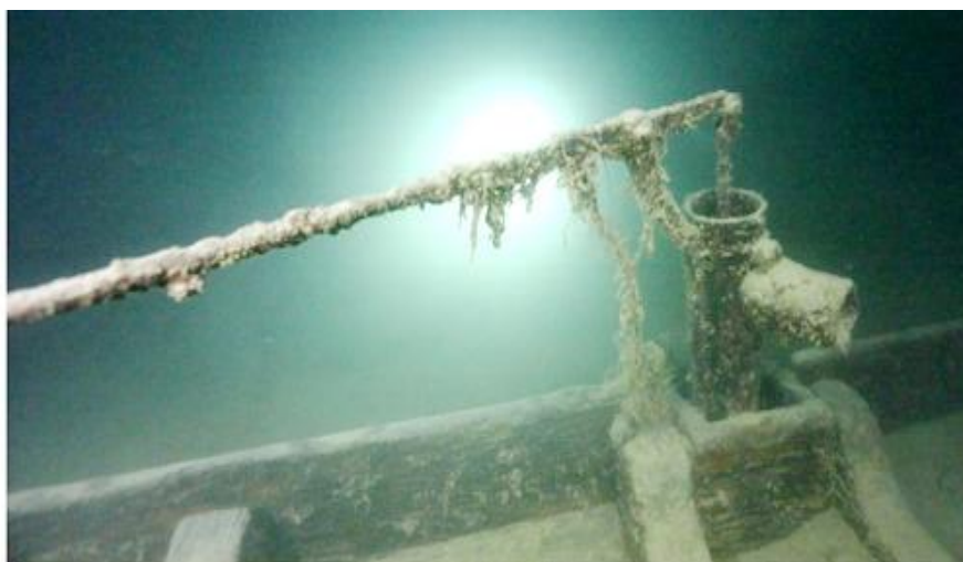
Schwengelpumpe, Lenzpumpe od. Hubkolbenpumpe, Gesamtlänge ca. 2 Meter
