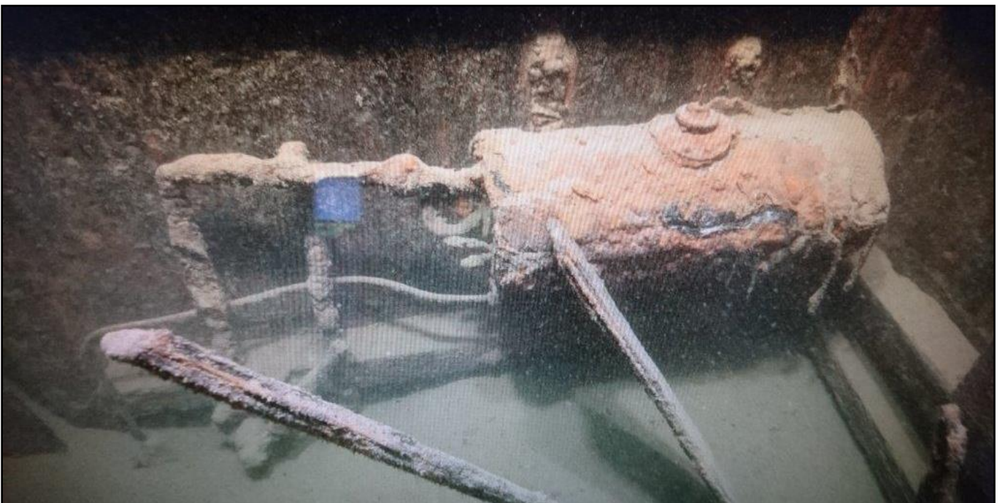
Kleiner Reinbenzintank (40 Liter) für das Vorwärmen des Schiffsmotors. Inhalt: Reinbenzin farblos
