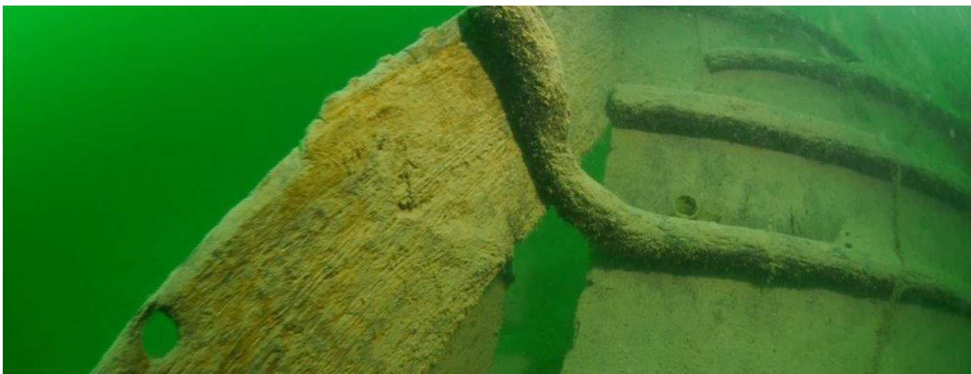
Heckteil, gut erkennbar ein Krummbalken (Gürbe) aus Tannenholz und das Loch für die Ruderschlaufe
