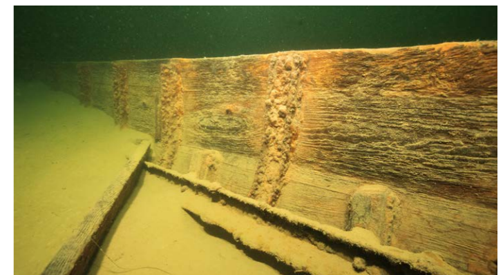
Metallträger deuten darauf hin, dass das Boot nachträglich erhöht wurde.
